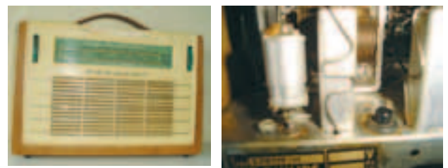
Philips L3X71T 'Sharpie' en zijn achterzijde/binnenwerk (rechtsonder een gemonteerde transistor, men had net als bij de buizentechniek ronde gaten in het chassis gemaakt. De transistor werd met een isolatietule in het gat geklemd).
